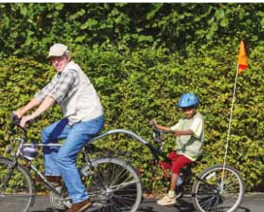
Aanhangfiets met koppelingspunt onder het zadel
