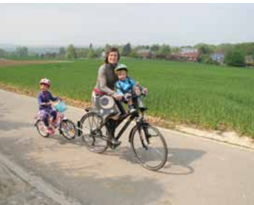
Fietsstoeltje vooraan en fietsstang voor het aankoppelen van een kinderfiets
